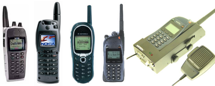
Abbildung 1: GSM-ASCI-Endgerät (links), zwei Tetra-Endgeräte (Mitte), zwei Tetrapol-Endgeräte, davon eines mit KFZ-Adapter (rechts)
